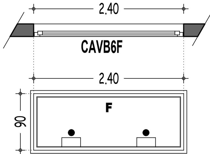
**CAVB6F:Fenêtre à châssis aluminium vitré fixe de 240x90 cm, vitrage pare-balles de sécurité de classe de résistance BR5 au sens de la norme EN 1063 sur lequel est installé au droit des passes sons, au niveau du comptoire est encastrés un passe-documents (15x 30 cm ) espaces de 1,50m ( voir plan callepinage)dotée d'un passe-documents coté sortie**
