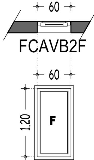
**FCAVB2F:** Fenêtre à châssis aluminium vitré fixe de 60x120 cm, vitrage pare-balles de sécurité de classe de résistance BR5 au sens de la norme EN 1063 ,(coté poste de garde)
