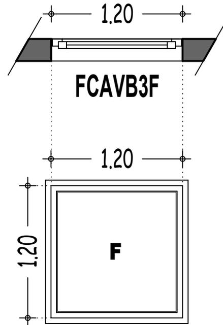
**FCAVB3F: Fenêtre à châssis aluminium vitré fixe
