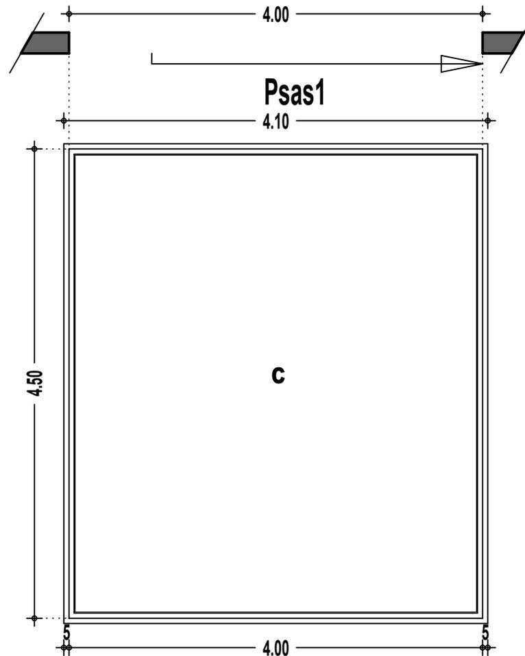
**Psas1**: Porte métallique coulissante (intérieur BCEAO) de 400x450 cm (passage libre), tôlée sur les deux faces avec un barreaudage intérieur en fer plein de 25x25 mm espacement de 11 cm entre barreaux, des traverses en fer plein de 25x25 mm à tous les 50 cm, interverrouillée avec la porte Psas2, à verrouillage télécommandé en dual (Poste de contrôle sécurité et poste de garde)
