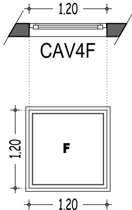
**CAV4F:Châssis aluminium vitré fixe
