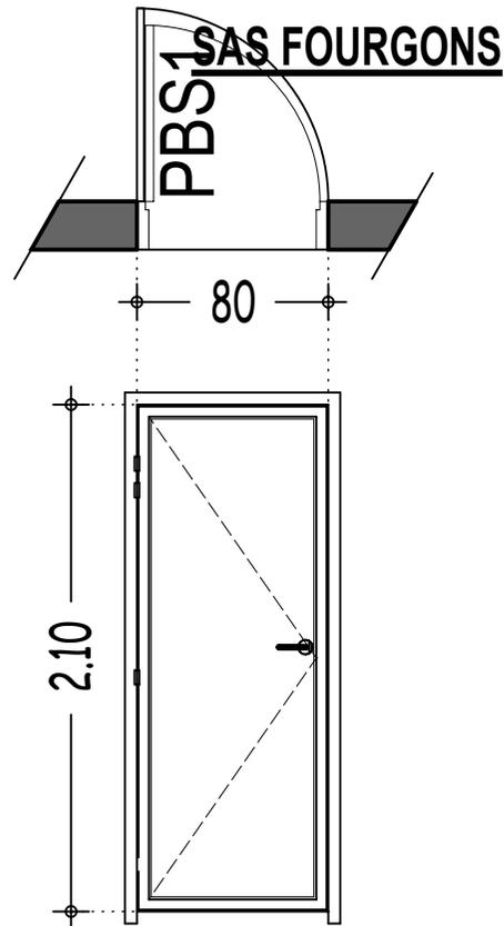
PBS1: Porte en bois stratifié de dimension 80x210 dotée de serrure à mortaiser pour cylindre européen avec cadre en bois massif et âme composée de panneaux de contreplaqué collés et revêtus de feuilles de massif haute pression.
