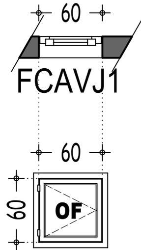
**FCAVJ1:Fenêtre à châssis aluminium vitré
